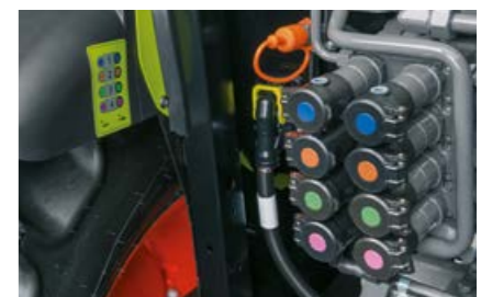
Priključci straga lako se prepoznaju po kodiranju u boji i naljepnicama postavljenim u blizini.
