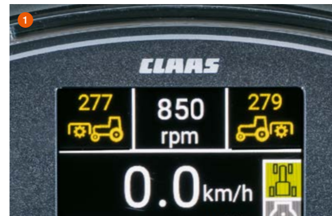
1 Zahvaljujući digitalnom prikazu brzine za prednje i stražnje priključno vratilo, uvijek radite odgovarajućom brzinom.
