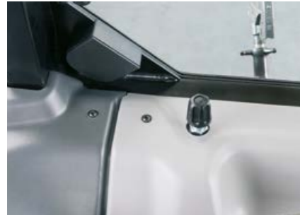
Maksimalni protok mehaničke upravljačke jedinice br. 3 može se ograničiti ručkom iz kabine.
