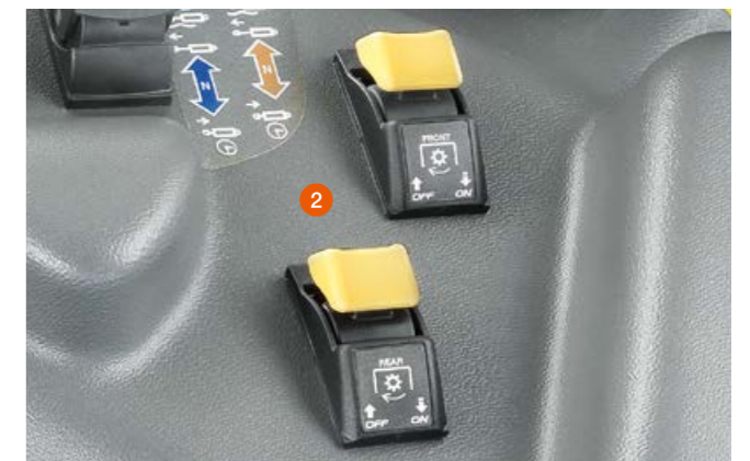
2 Prednje i stražnje priključno vratilo mogu se jednostavno aktivirati pritiskom na gumb.
