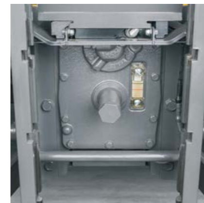
Razinu ulja u prijenosniku i hidrauličkom sustavu možete provjeriti kroz kontrolno staklo pored rukavca priključnog vratila.
